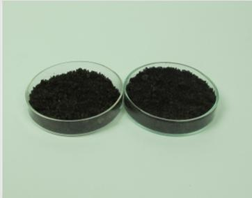
Наполните две чашки Петри диаметром 100 мм сухой садовой почвой высотой примерно 1 см. Очень важно, чтобы эта земля была полностью сухой.
