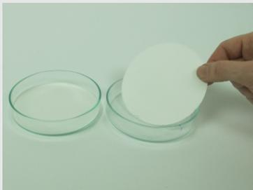
Поместите по три круглых фильтра диаметром 90 мм каждый в две дополнительные чашки Петри диаметром 100 мм и разровняйте их по дну чашек.
